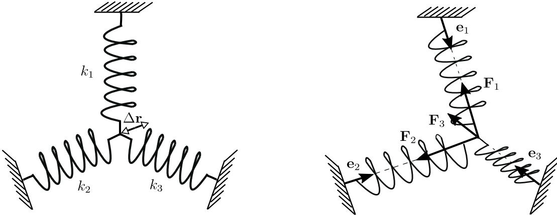
Рис. 1. Тензор жесткости системы пружин
