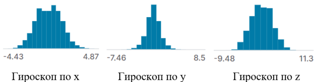
Рисунок 7 – Распределение данных по показаниям гироскопа, соответственно по каждой из трех осей, x, y и z.
