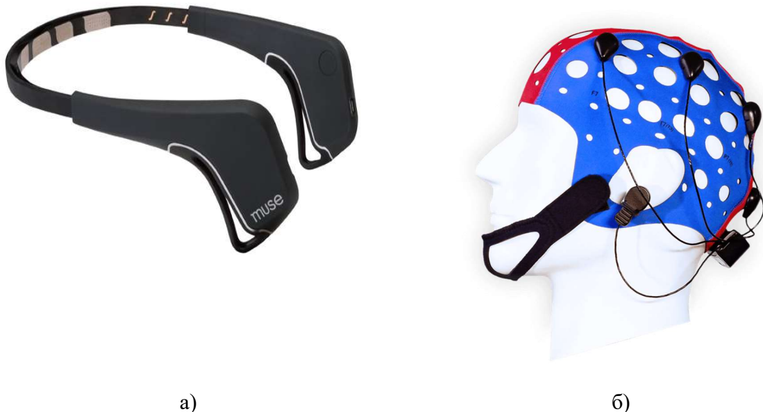
Рис. 2.3. Используемые в работе нейроинтерфейсы: Muse (а), NeuroPlay8-cup (б)
