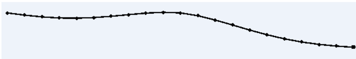
Рисунок 4. Балка с нанесенной сеткой в деформированном состоянии
