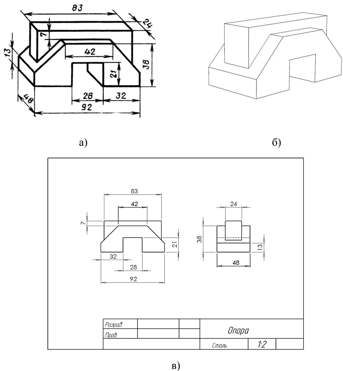
Рисунок 4. Опора: а – задание; б – готовая деталь; в – чертеж
