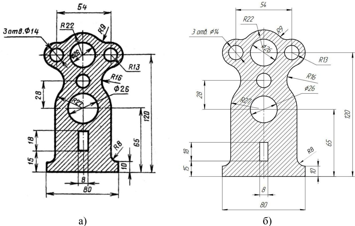
Рисунок 2. Стойка: а – задание; б – готовый эскиз детали
