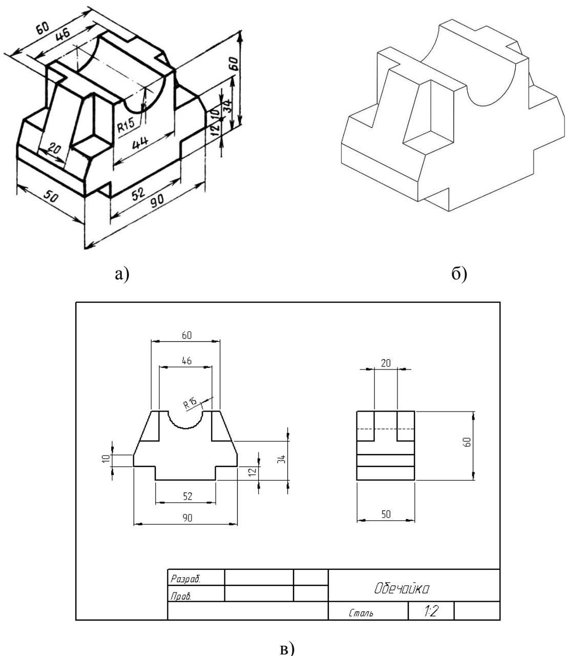
Рисунок 5. Обечайка: а – задание; б – готовая деталь; в – чертеж
