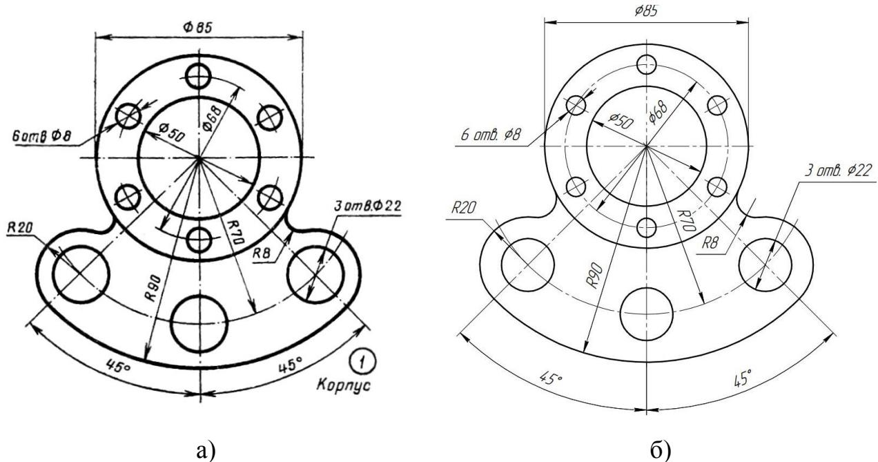
Рисунок 1. Корпус: а – задание; б – готовый эскиз детали
