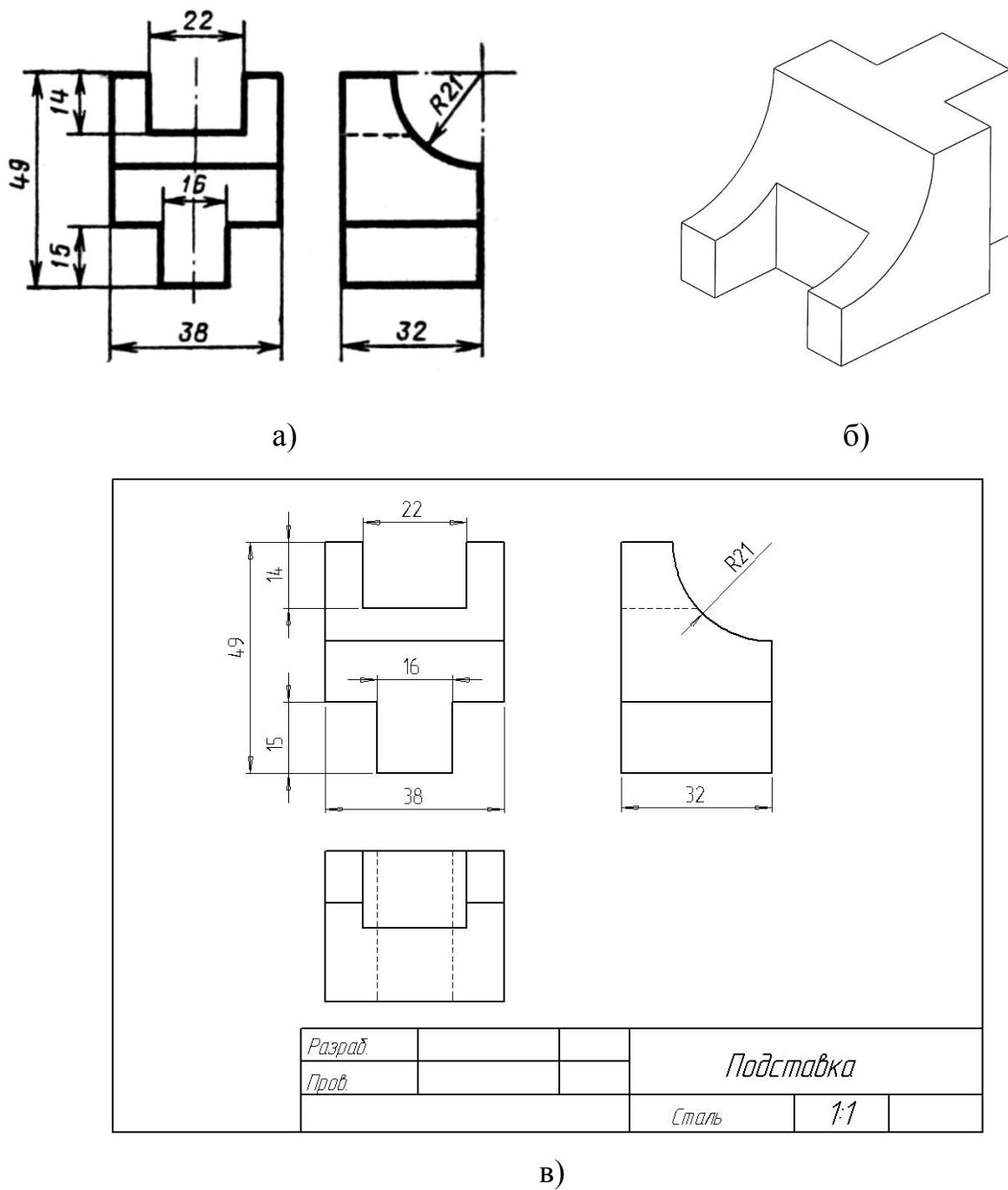
Рисунок 8. Подставка: а – задание; б – готовая деталь; в – чертеж
