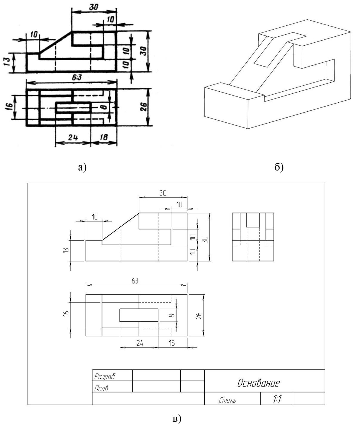
Рисунок 9. Основание: а – задание; б – готовая деталь; в – чертеж
