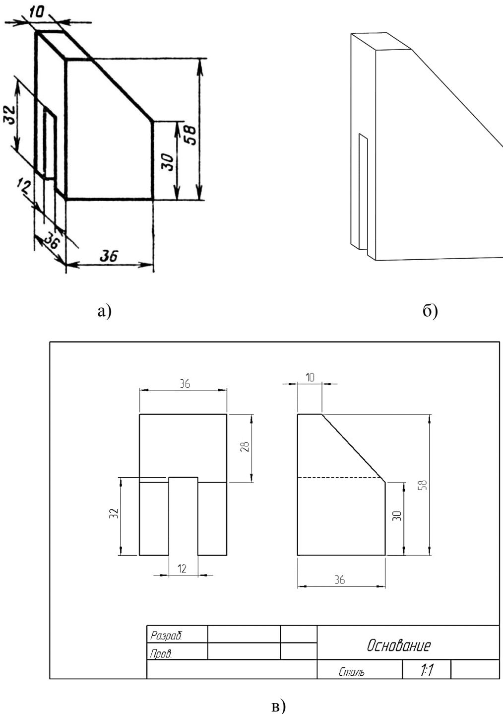
Рисунок 3. Основание: а – задание; б – готовая деталь; в – чертеж
