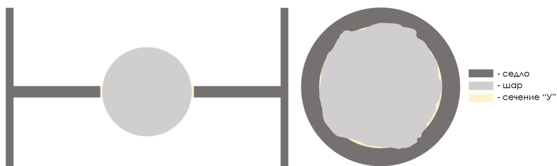
Рис. 1.5. Физическая модель с просветом между седлом и шаром изношенного обратного клапана
