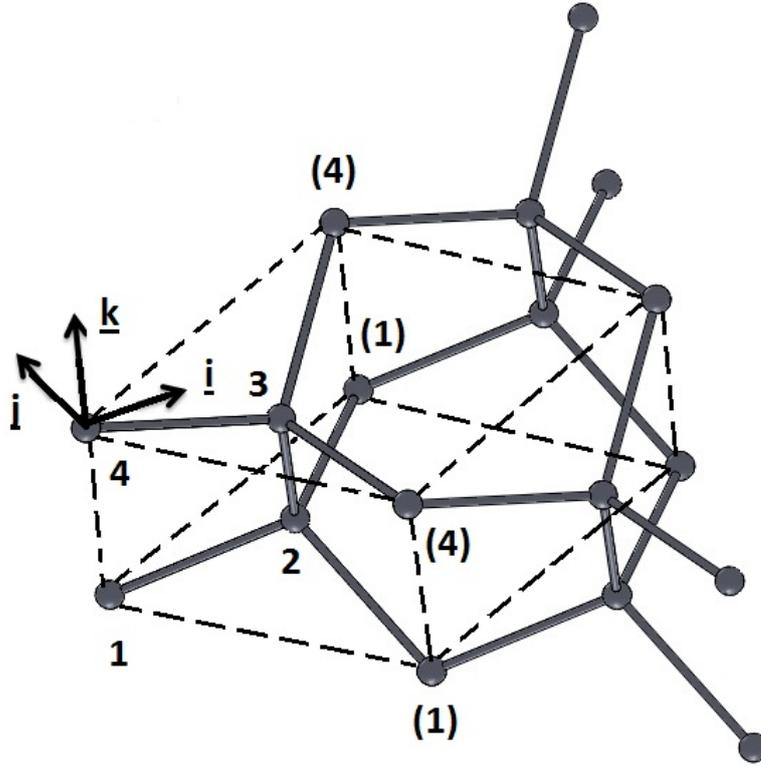
Рис. 3: Элементарная ячейка решетки лонсейлита
