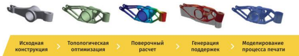
Рис.2. Симуляция цикла аддитивного производства в Ansys.
