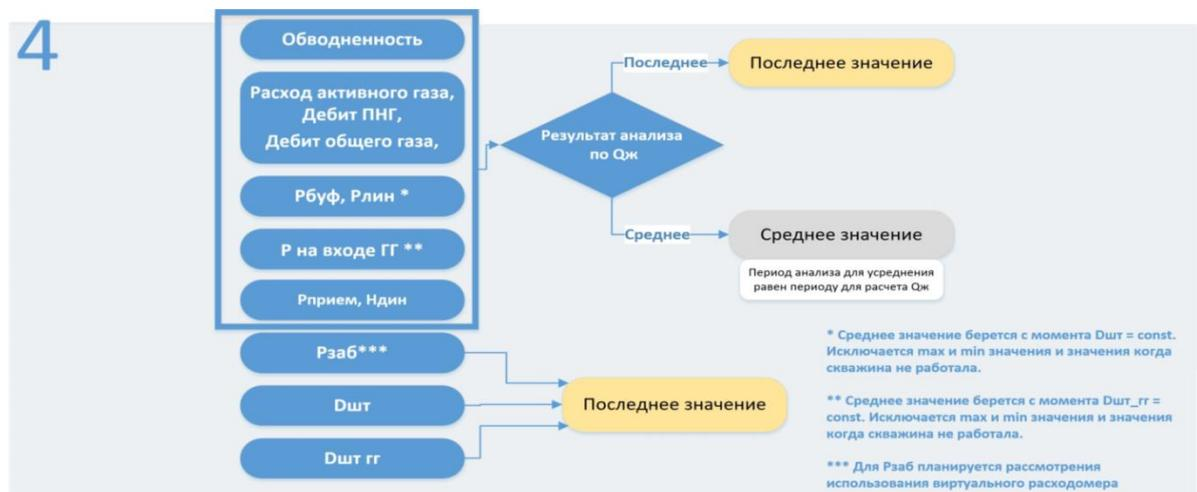
Рисунок 13. Расчет остальных параметров.
