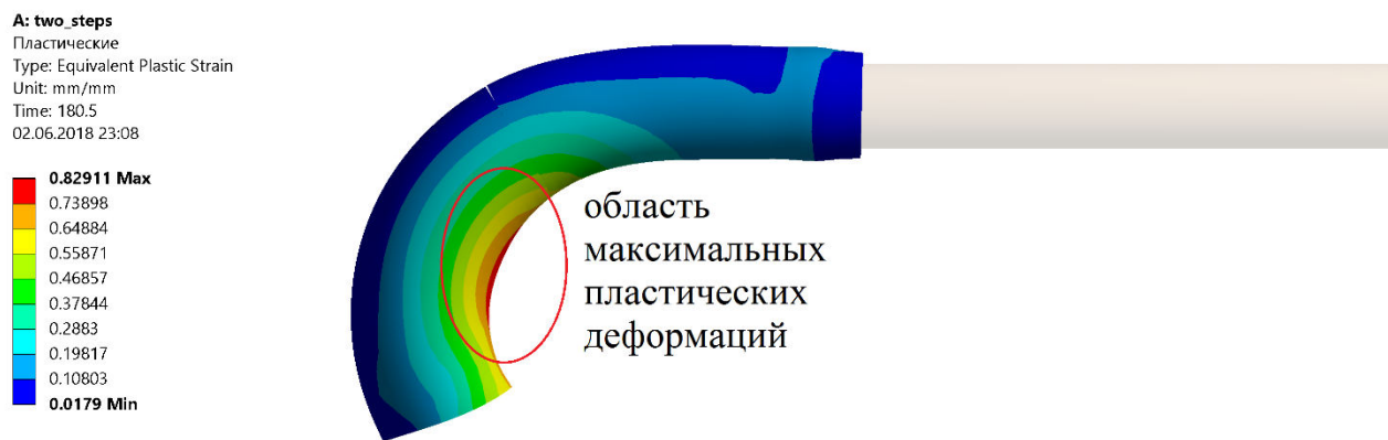
Рисунок 4.2 – Пластические деформации в трубах-заготовках
