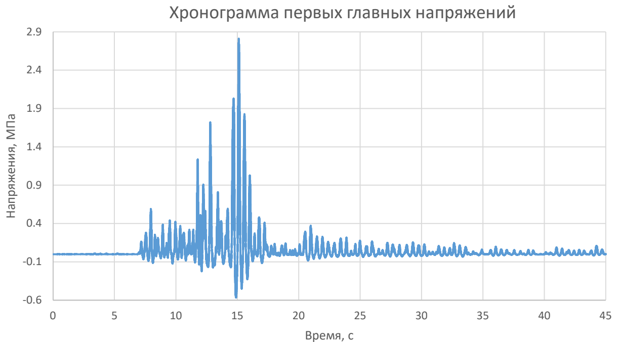
Рисунок 29. Max Principal Stress в самом нагруженном узле, МПа.
