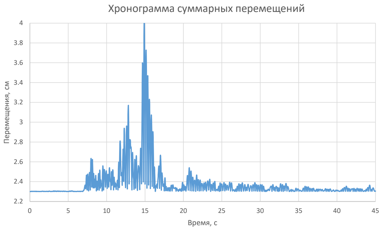
Рисунок 38. Суммарные перемещения в узле на гребне плотины, см
