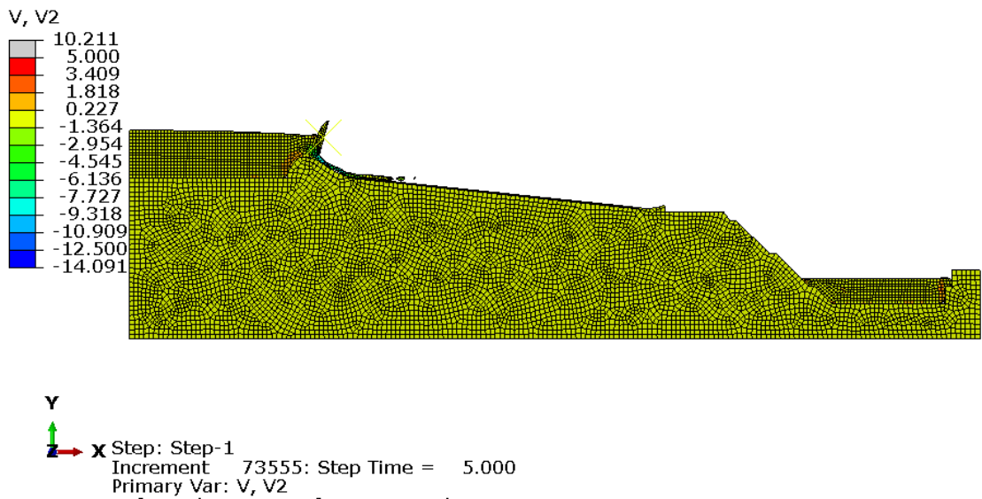
Рисунок 9а. Скорость в вертикальном направлении потока в момент времени t = 5\text{c} .
