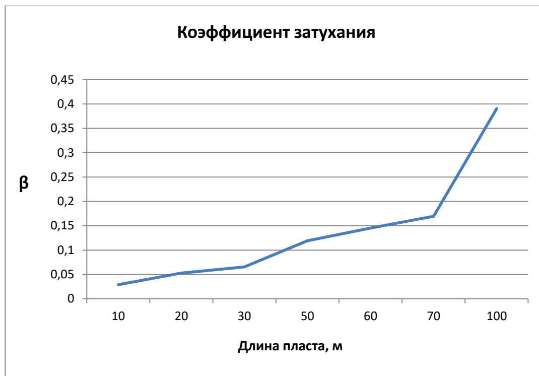
Рисунок 11. Зависимость коэффициента затухания от длины пласта
