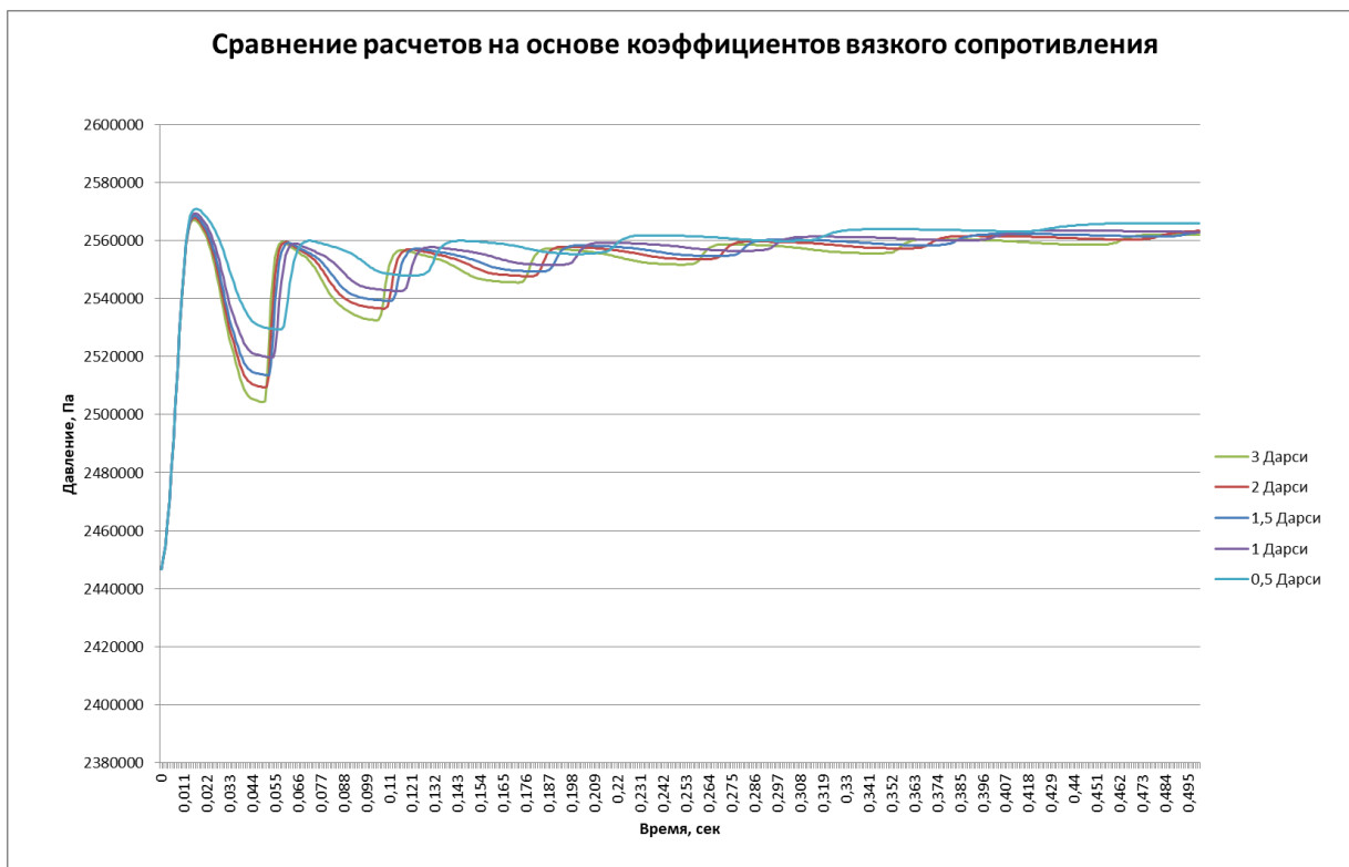
Рисунок 29. Сравнение колебаний давления при различных коэффициентах вязкого сопротивления
