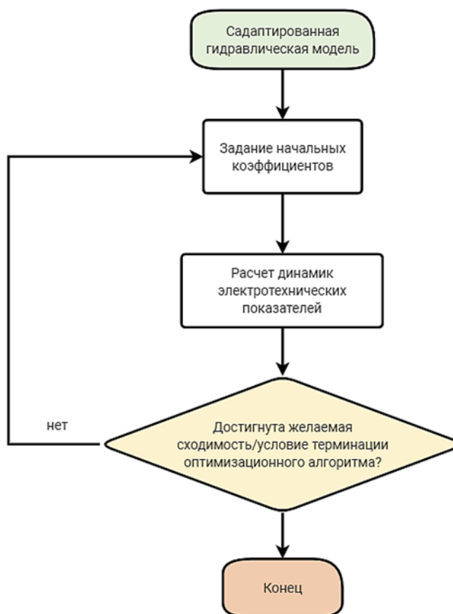
Рисунок 2.3. Логическая схема алгоритма адаптации электротехнических параметров модели скважины
