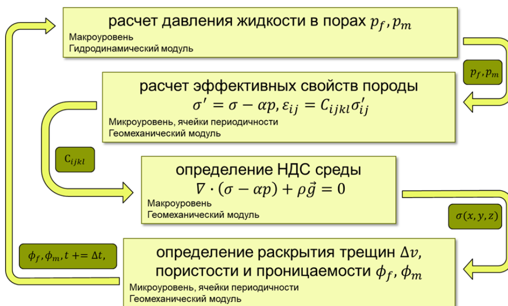
Рис. 7: Внутренние итерации в методе расщепления по физическим процессам для решения связанной гидрогеомеханической задачи о фильтрации жидкости сквозь пористую трещиноватую породу
