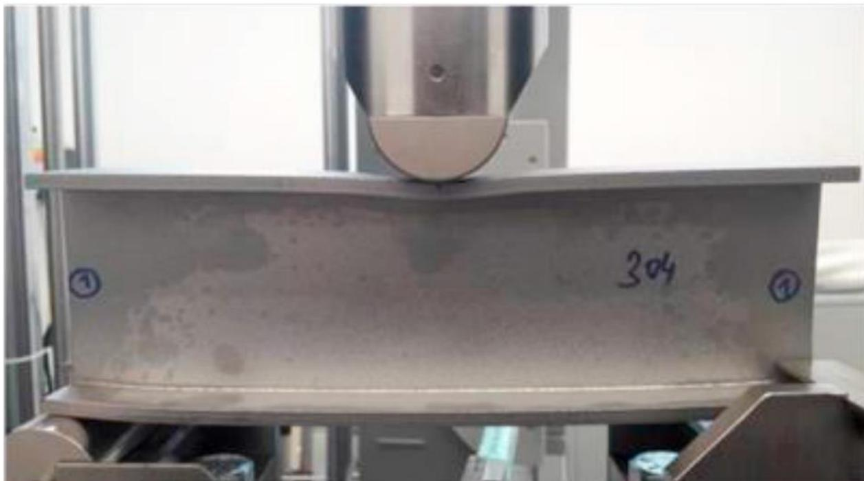
Рисунок 3.2 – Установка для проведения эксперимента на трёхточечный изгиб балки [11]
