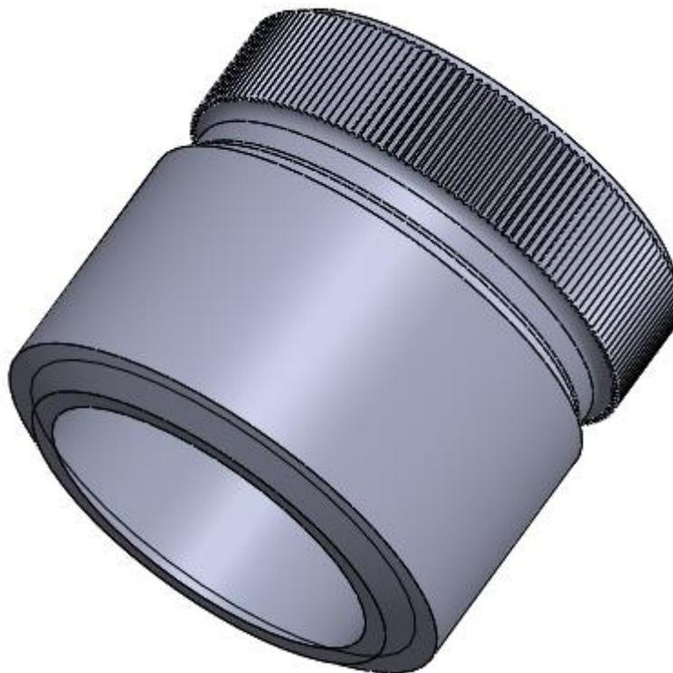
Рисунок 7. Модель детали «Головка редуктора».
