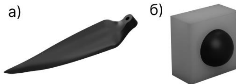
Рис. 2.2 – а) Твердотельная модель лопасти винта беспилотного летательного аппарата;
