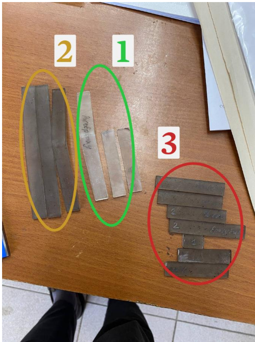
Рис. 4.4.2 – Тестовые выборки. 1 – Эпоксидная смола без включений; 2 – Эпоксидная смола с мелкодисперсными агломератами глобулярного углерода; 3 – Эпоксидная смола с крупнодисперсными агломератами глобулярного углерода.
