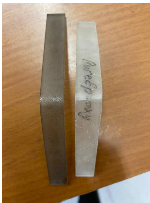
Рис. 4.4.3 – Сравнение двух образцов из чистой эпоксидной смолы и с добавлением мелкодисперсных агломератов глобулярного углерода.
