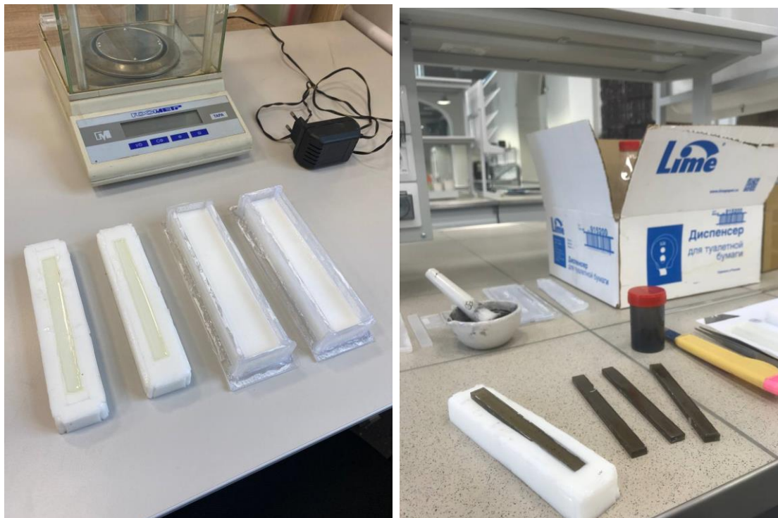
Рис. 4.3.5 – Заливка форм и получение образцов.
