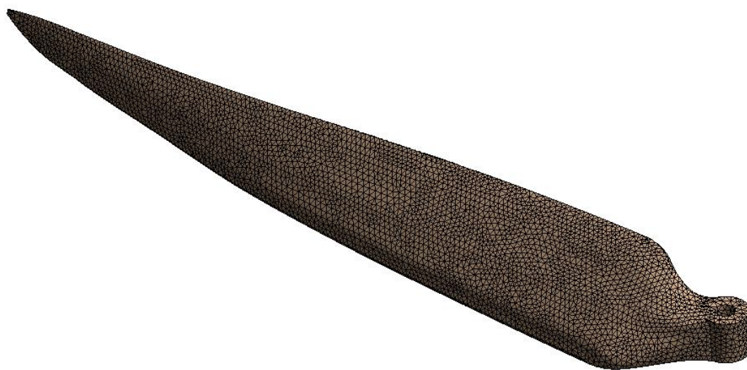
Рис. 5.1.5 – Конечно-Элементная модель лопасти сгенерированная в ANSYS Mechanical .
