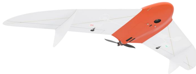
Рис. 2.1 – Беспилотный летательный аппарат самолетного типа (Геоскан 201 Геодезия).
