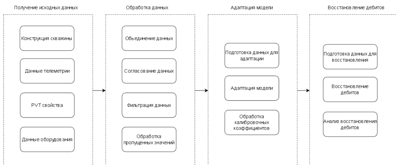
Рис.3.2. Архитектура модуля виртуальной расходомерии для скважин с ЭЦН на базе физической модели.
