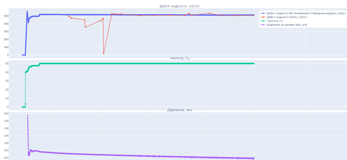
Рис.4.4. Пример восстановления дебита с помощью гибридного алгоритма виртуального расходомера для скважины 13.
