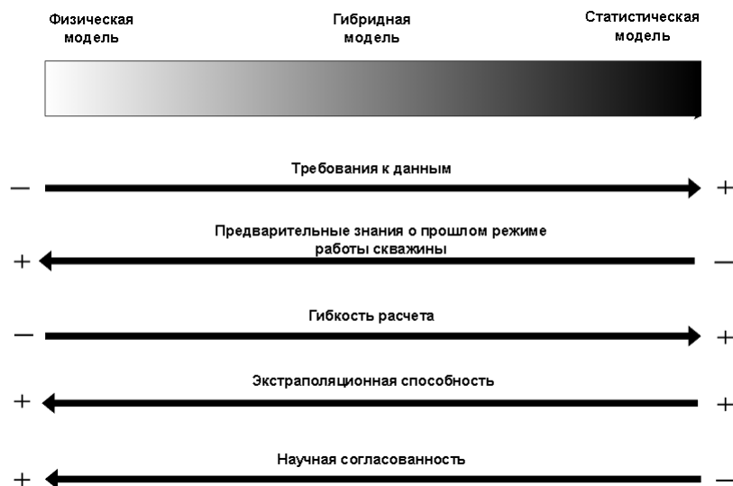
Рис.1.1. Диапазон моделей виртуального расходомера от «белого ящика» до «черного ящика» и некоторые их характеристики [12]
