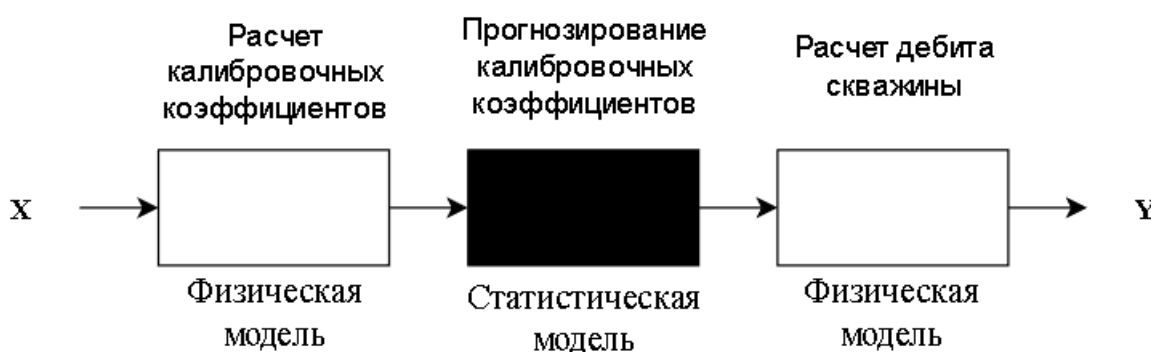
Рис.3.1. Схема построения гибридной модели.
