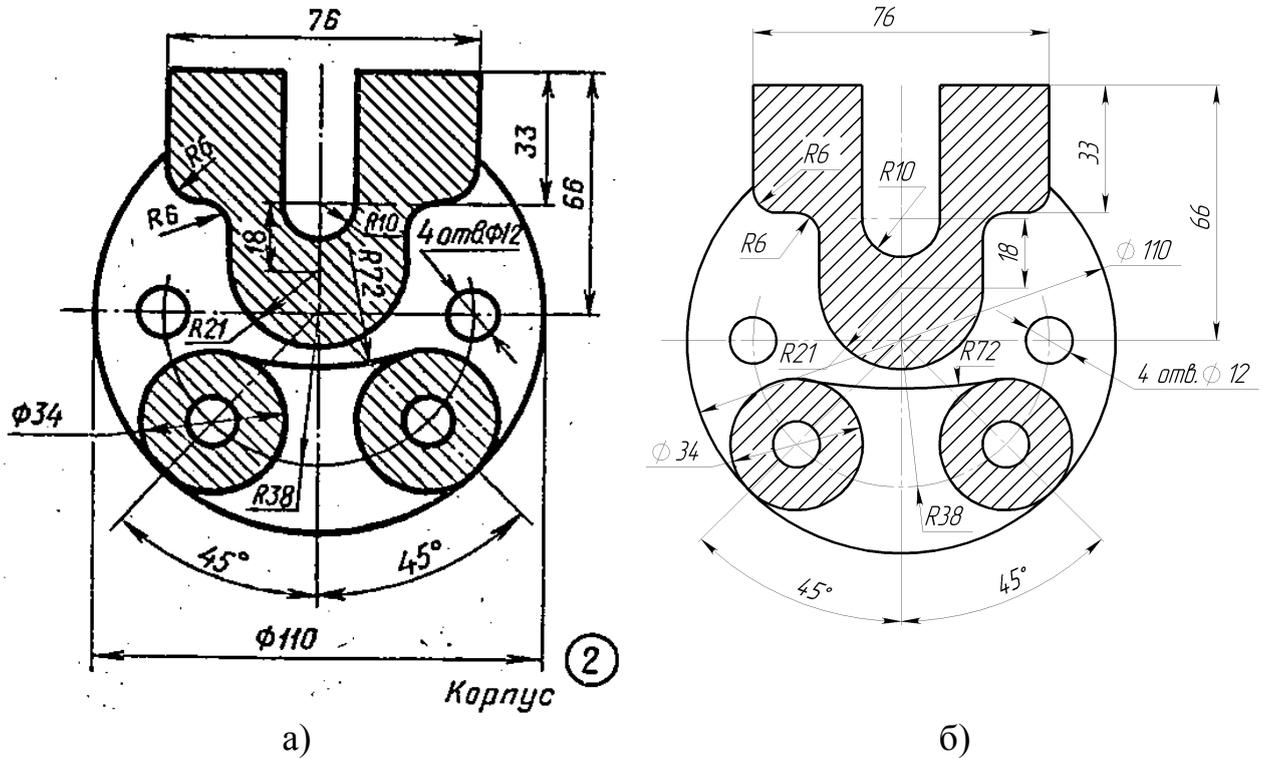
Рисунок 2. Корпус: а – задание; б – готовый эскиз детали
