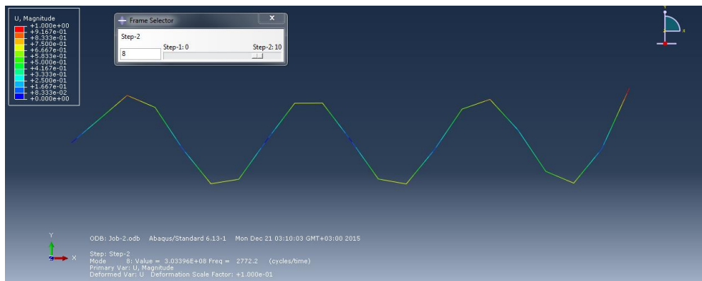
Рисунок 16. Форма колебаний на частоте 2772.2 с -1
