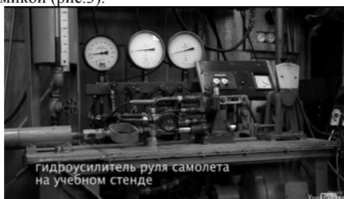
Рис. 3. Гидроусилитель руля самолета.
