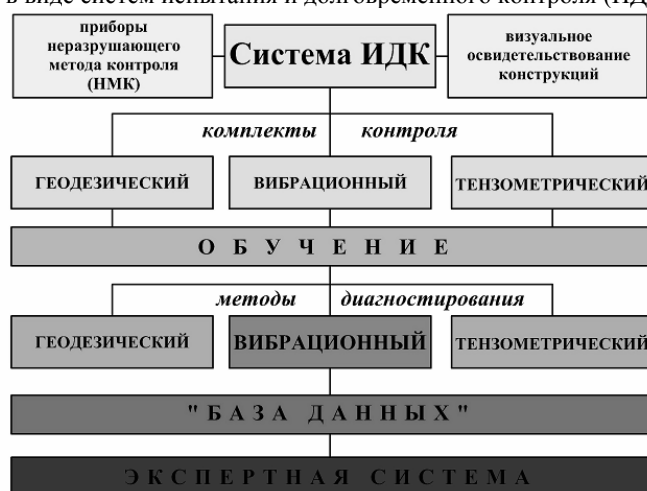
Рис. 1. Структурная схема системы ИДК на СС для запуска РКН [1].
