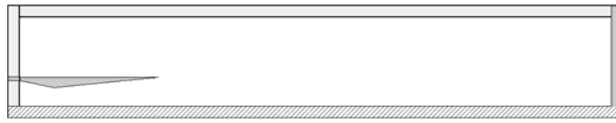
Рис. 3. Коническое сопло (конфигурация 2). Двумерная постановка.
