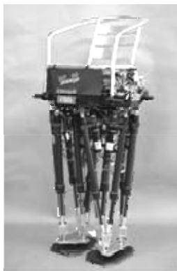
Рис. 5. Шагающее кресло WL-16 Серия Waseda-Leg, разработанное университетом Waseda University и фирмой Tmsuk.
