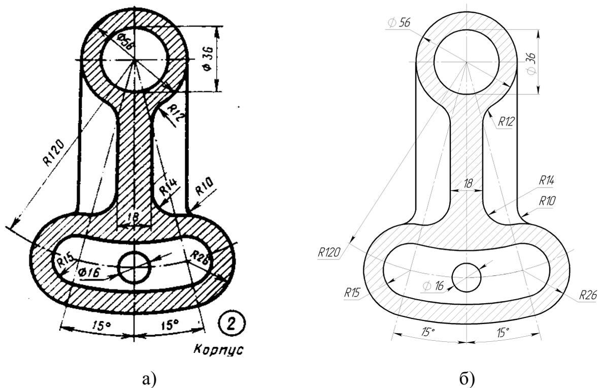
Рисунок 2. Корпус: а – задание; б – готовый эскиз детали
