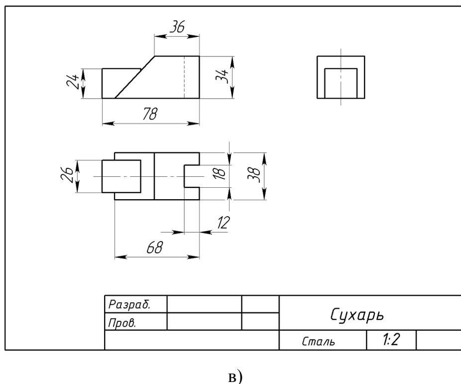
Рисунок 7. Сухарь: а – задание; б – готовая деталь; в – чертеж
