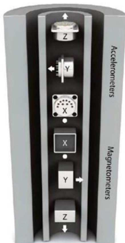
Рис. 6. Схема сочетания в зонде забойной телеметрической системы акселерометра и магнитометра
