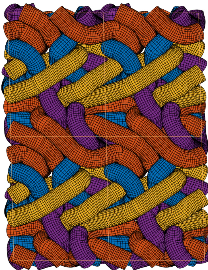
Рис. 37. Результат работы алгоритма для случайно сгенерированного двойкопериодического переплетения ( D = 1 )
