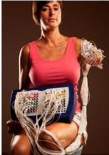
Рис. 7. Макет протезов с тактильным съемом биопотенциалов с поверхности тела человека с электродами и предусилителями
