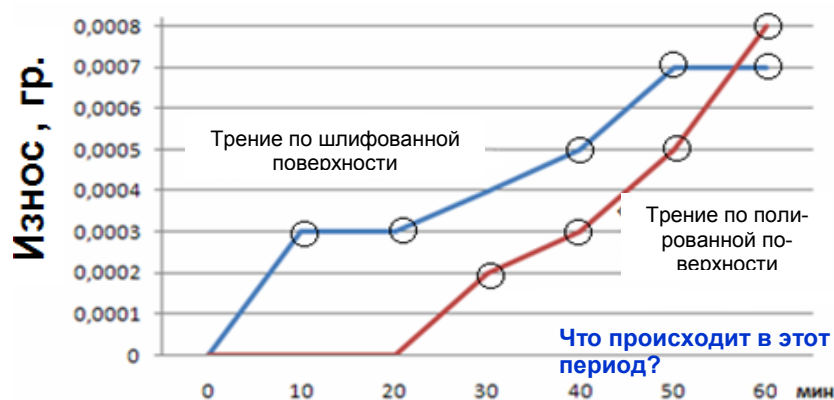
Рис. 14 Изменение веса полимерного образца при трении по стали (шлифованной и полированной поверхности)
