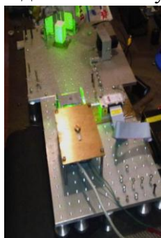
Общий вид спекл-интерферометрического дилатометра и его оптических элементов
