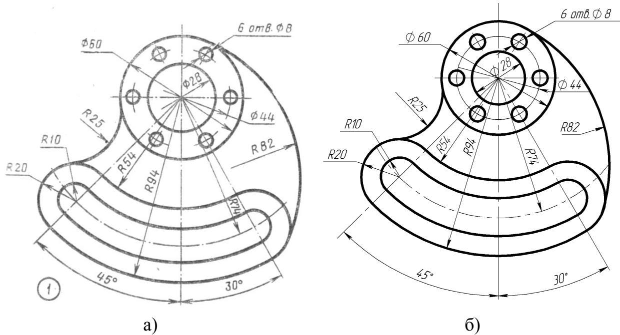
Рисунок 1. Держатель: а – задание; б – готовый эскиз детали
