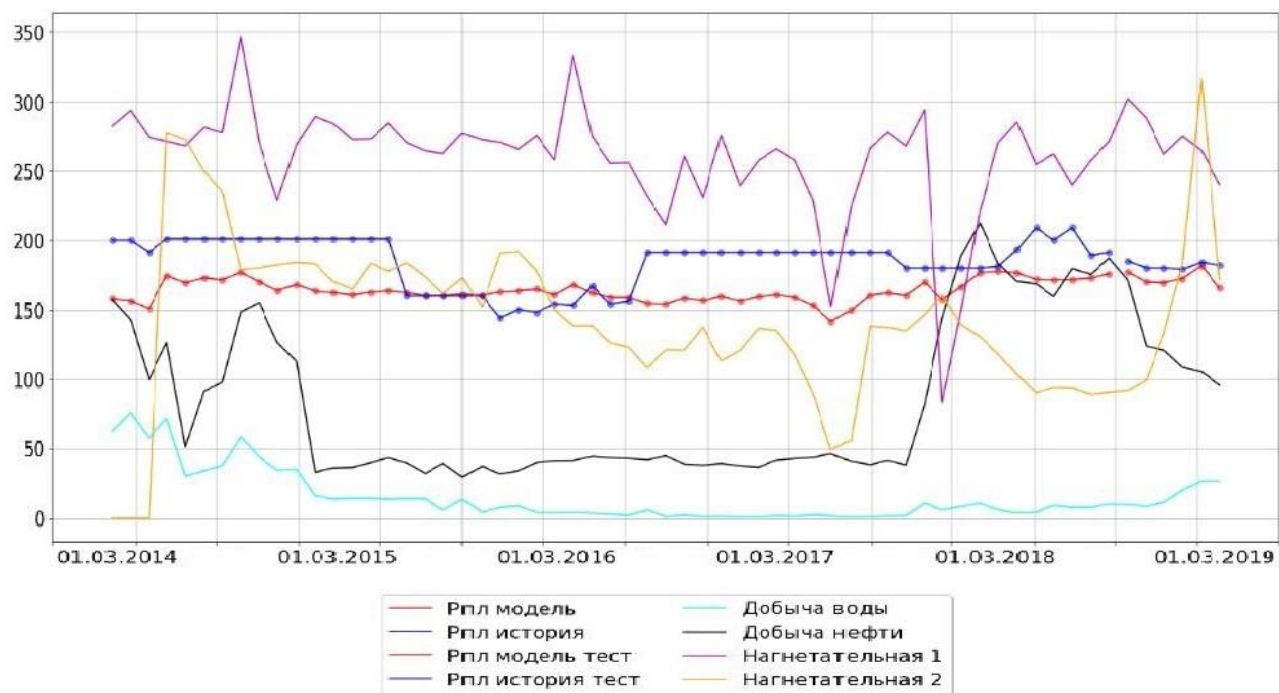
Рис. 7. Динамика исследуемых параметров для скважины № 10.
