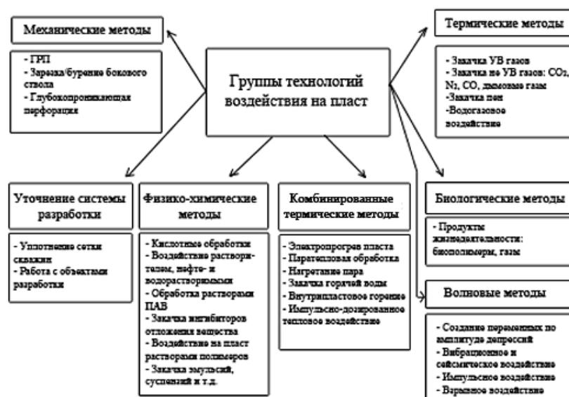
Рис 1. Классификация методов интенсификации добычи
