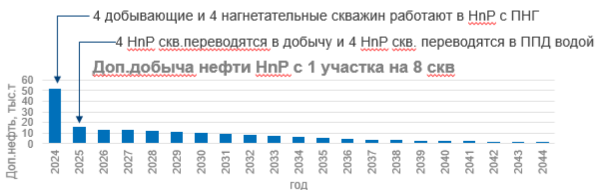
Рис.3.4. Дополнительная добыча нефти при проведении Huff-and-Puff в течении 1 года
