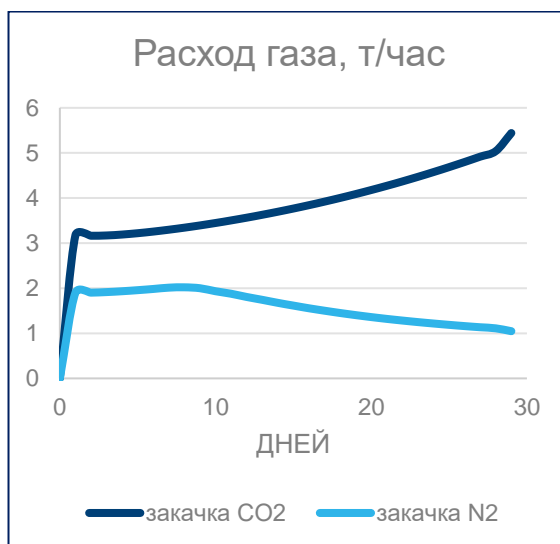
Рис. 3.6. Расход газа при закачке CO 2 и N 2
