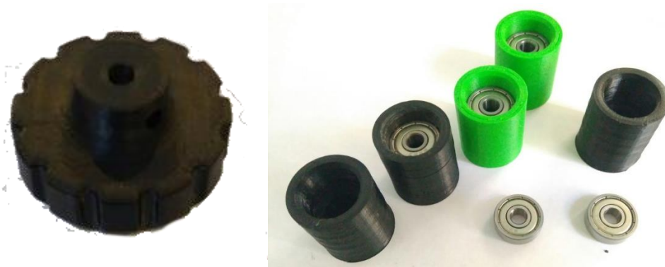
Рисунок 6.4.3 Детали после печати: рукоятка и ролики.
