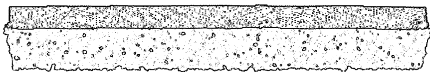
Рис. 14: Результат плоского удара по поликристаллическому образцу. Исходная пористость мишени 30%.
