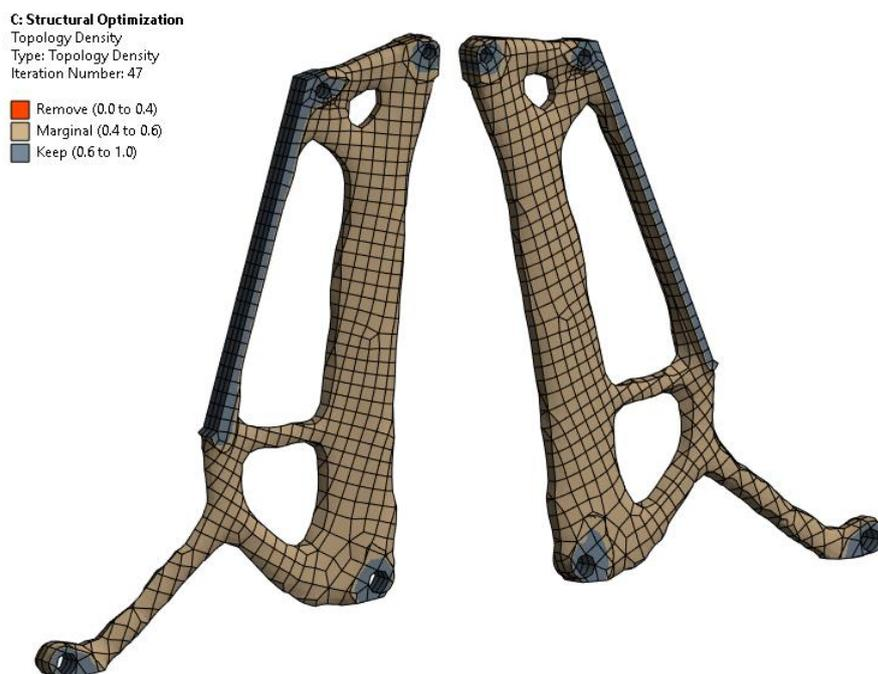
Рисунок 3.2.15. Результат топологической оптимизации.
