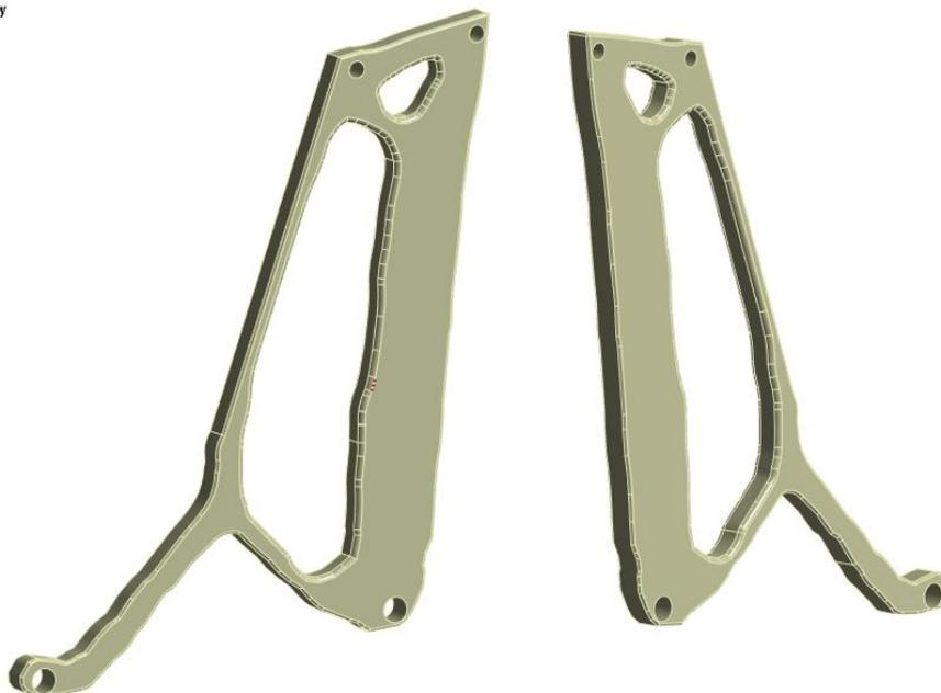
Рисунок 3.2.7. Геометрия кронштейна для аддитивного производства.
