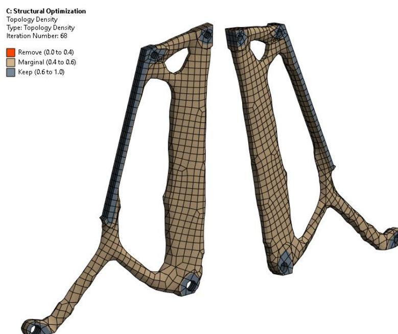
Рисунок 3.2.6. Форма кронштейна после топологической оптимизации.
