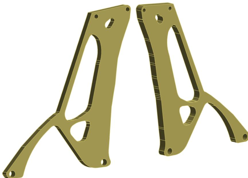
Рисунок 3.2.26. Готовая к традиционному производству модель.
