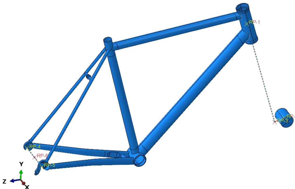
Рисунок 38. Модель рамы для испытания на усталость от горизонтальных сил
