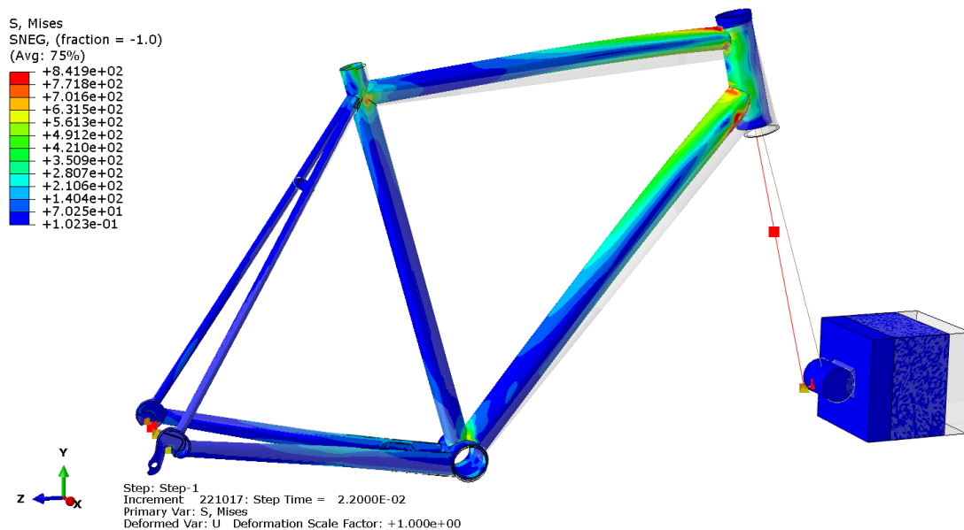
Рисунок 20. Поле напряжений по Мизесу на измененном положении рамы на 0,022 секунде испытания по сравнению с начальным, МПа
