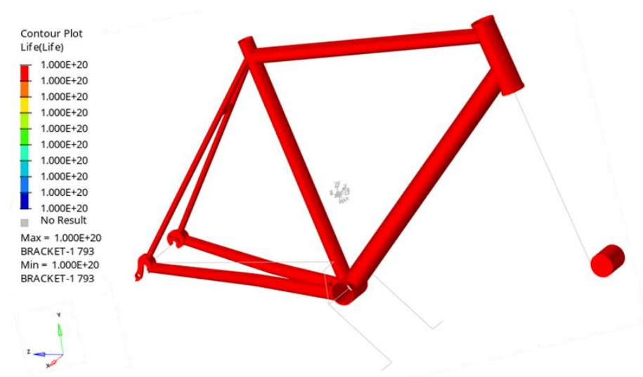
Рисунок 36. Поле усталостного ресурса для испытания с усилиями в педальном узле
