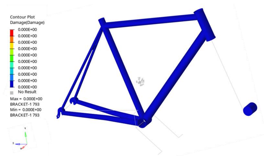
Рисунок 35. Поле усталостных повреждений для испытания с усилиями в педальном узле
