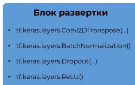
Рисунок 3.10. Блок развёртки нейронной сети
