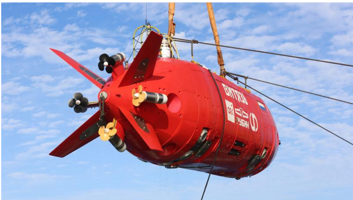
Рис. 6. Двигательный комплекс АНПА «Витязь Д»
