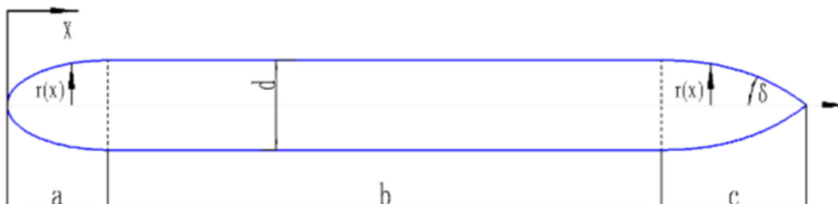
Рис. 2. Геометрическая форма корпуса
