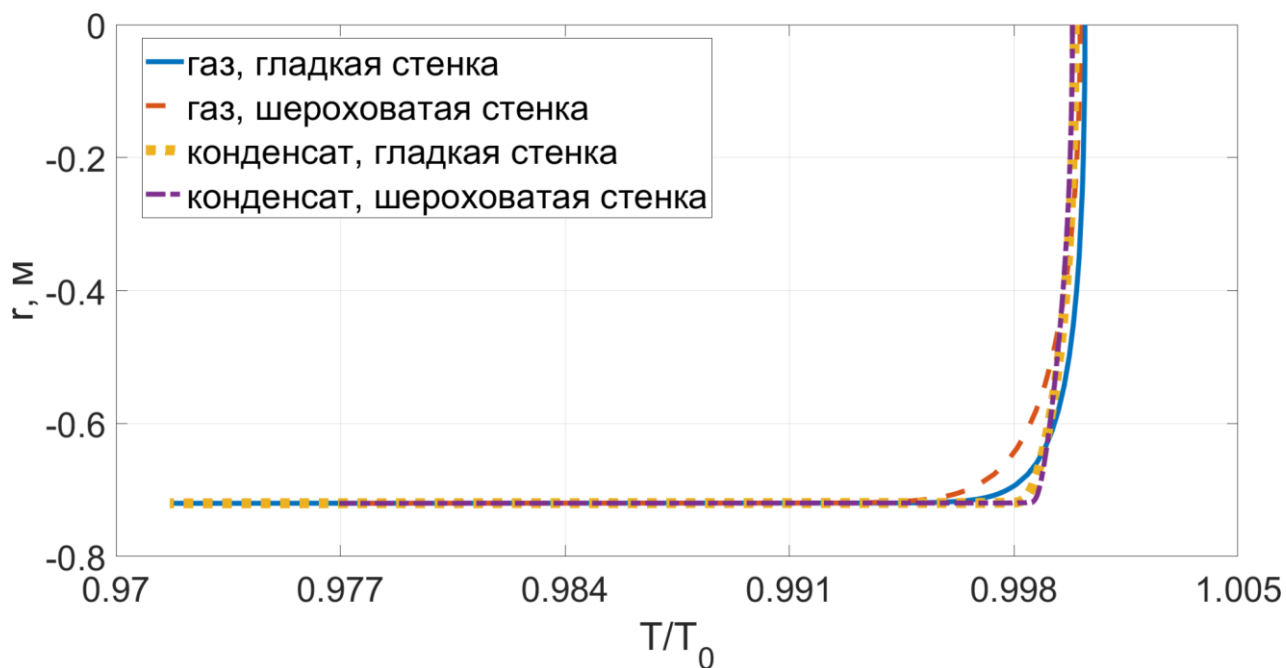
Рис.3.2. Профили относительной температуры для туманообразного режима течения
