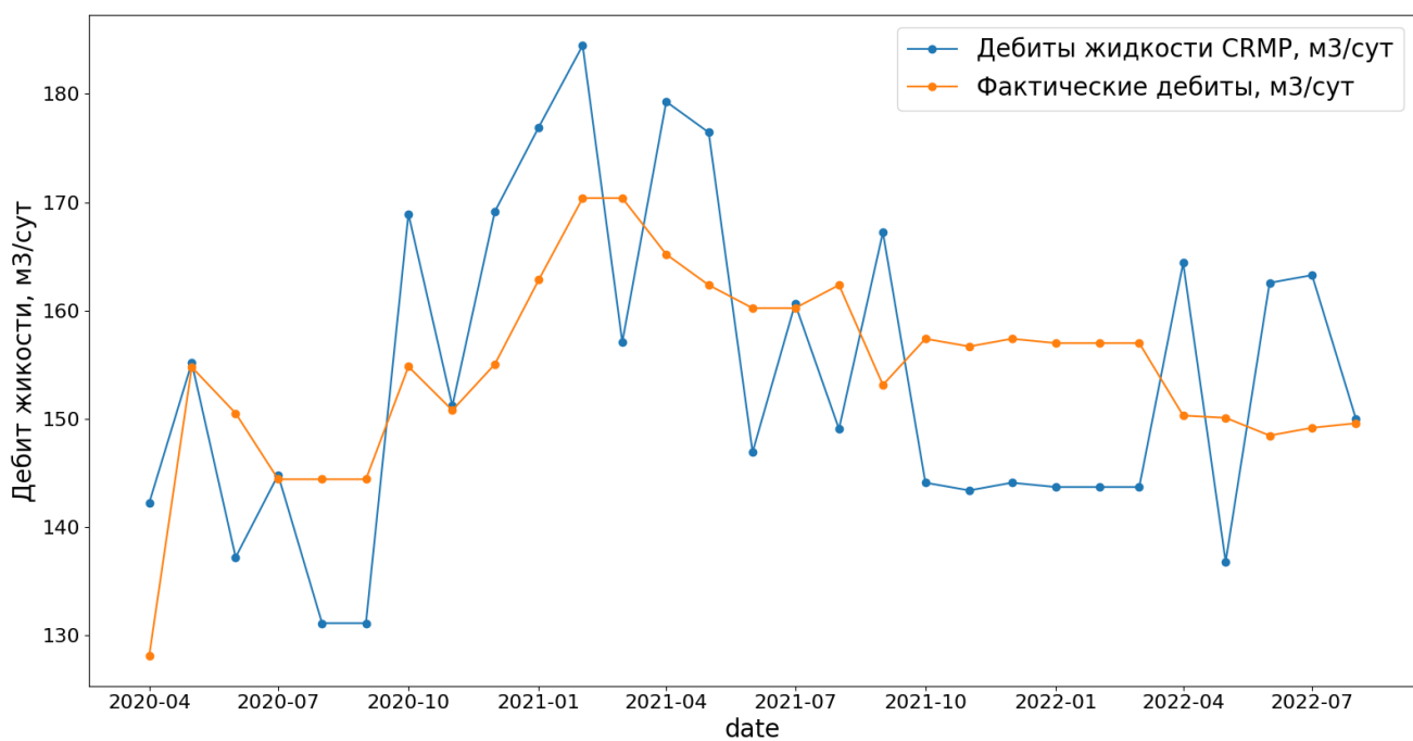
Рисунок 13. Графики динамики расчетного и фактического дебитов жидкостей добывающей скважины P4
